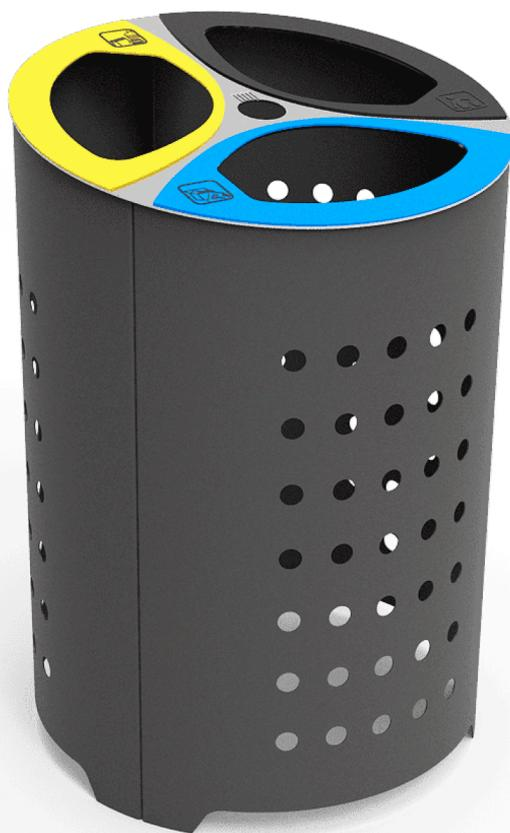
La papelera Doria está destinada a la separación del material reciclable. Incorpora cenicero. El cuerpo de la papelera es de chapa de acero de 2 mm, perforada con aro de refuerzo. Cuerpo con tratamiento por cataforesis y pintura al horno en color negro, Tapa superior de acero inoxidable AISI 304, con 3 agujeros, lo que impide que la gente pueda tirar las bolsas de basura doméstica.
