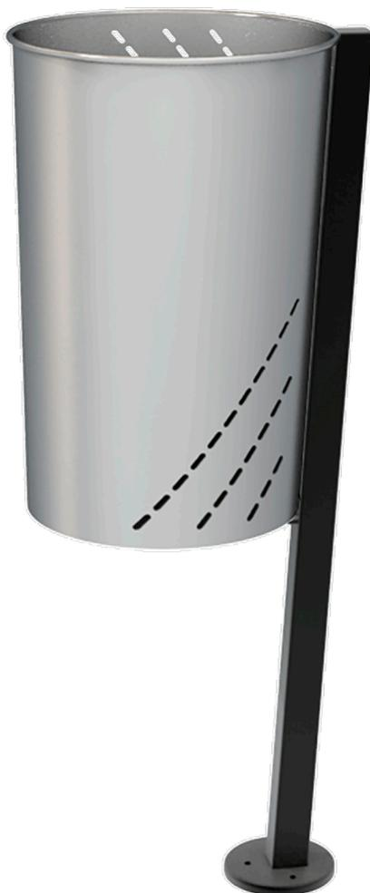
Cubeta y estructura en acero zincado, poste de sujeción de acero galvanizado de sección cuadrada. Cubeta abatible con cierre mediante llave. Acabado: Imprimación epoxi y pintura poliéster en polvo color negro forja y RAL 9006. Instalación: Fijación al suelo mediante 3 tornillos Ø8, no suministrados.
